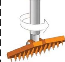
A PARTE INFERIOR DOS CALÇOS É DENTADA O QUE AUXILIA NA PARTE DA ADERÊNCIA COM O SOLO
