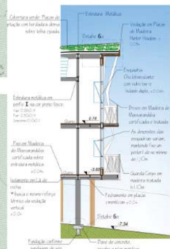
DETALHE 6 - Corte de Pele 1:50
