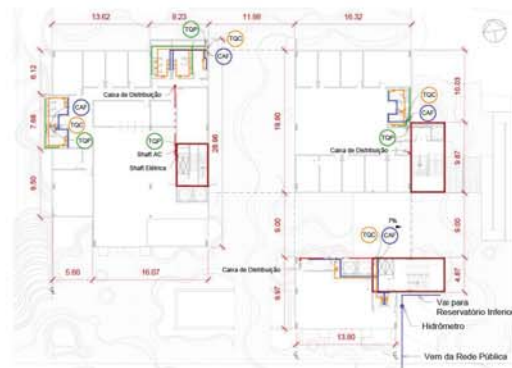
1 Pavimento Terreno Esc. 1:200
