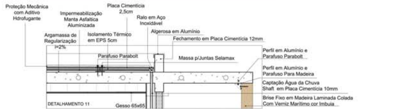
DETALHAMENTO 6 - COBERTURA Esc. 1:20
