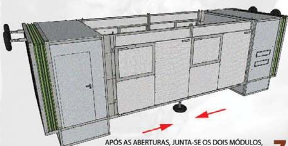
APÓS AS ABERTURAS, JUNTA-SE OS DOIS MÓDULOS, POR ENCAIXE "MACHO E FEMEA" E PARAFUSO 7
