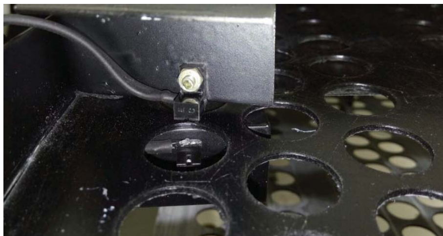
Figura 23 – Suporte fixação sensor de sincronismo.
