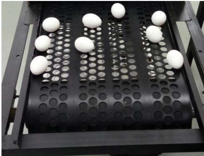
Figura 21 – Cantoneiras de contenção.
