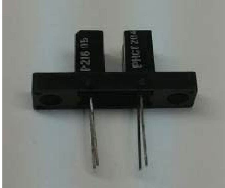
Figura 29 – Sensor optico PHCT204.
