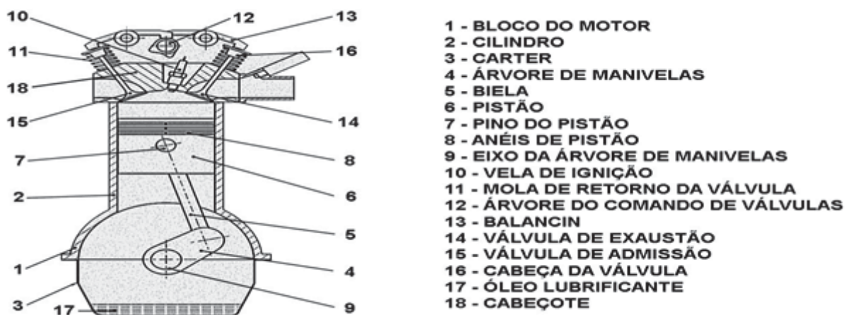
Figura 1 – Principais componentes de um motor de combustão de ciclo Otto.
