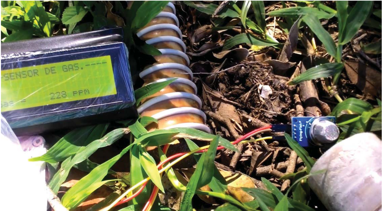
Figura 36 - Teste de Gás, no Bocal de Saída do Biodigestor. Valor Máximo Obtido.
