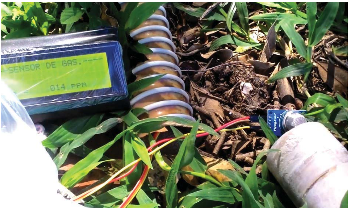
Figura 35 - Teste de Gás, no Bocal de Saída do Biodigestor. Início do Teste.
