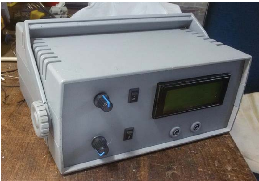
Figura 46 - Caixa de acoplamento finalizada
