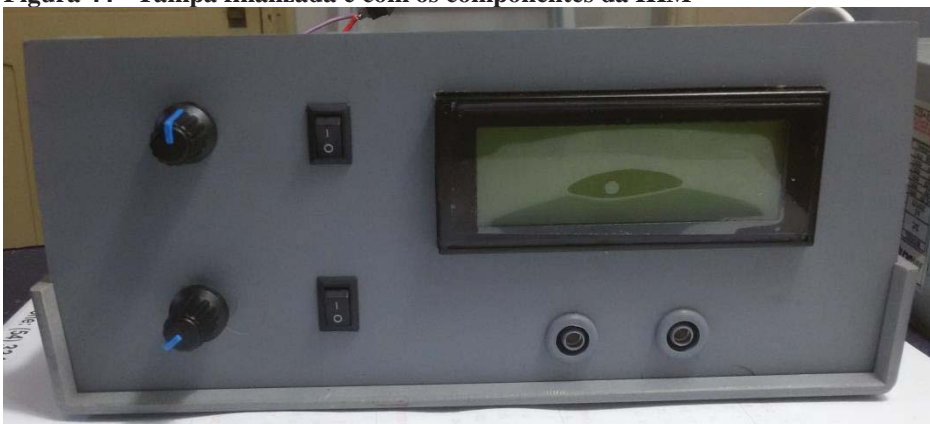
Figura 44 - Tampa finalizada e com os componentes da IHM
