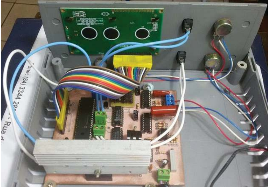
Figura 45 - Detalhe da ligação dos componentes da IHM
