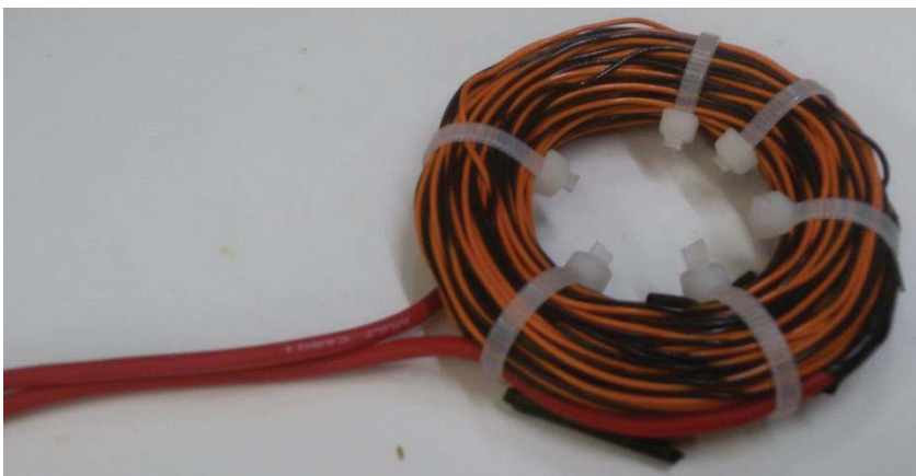
Figura 5 - Bobina de Mishin com enrolamento Toroidal utilizada para o projeto
