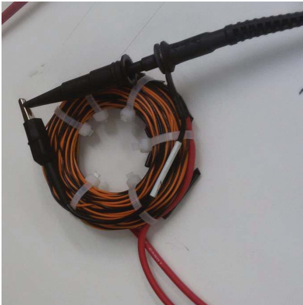
Figura 6 - Método para medir a indução na bobina
