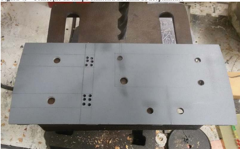
Figura 43 - Confecção da tampa dianteira da caixa de acoplamento
