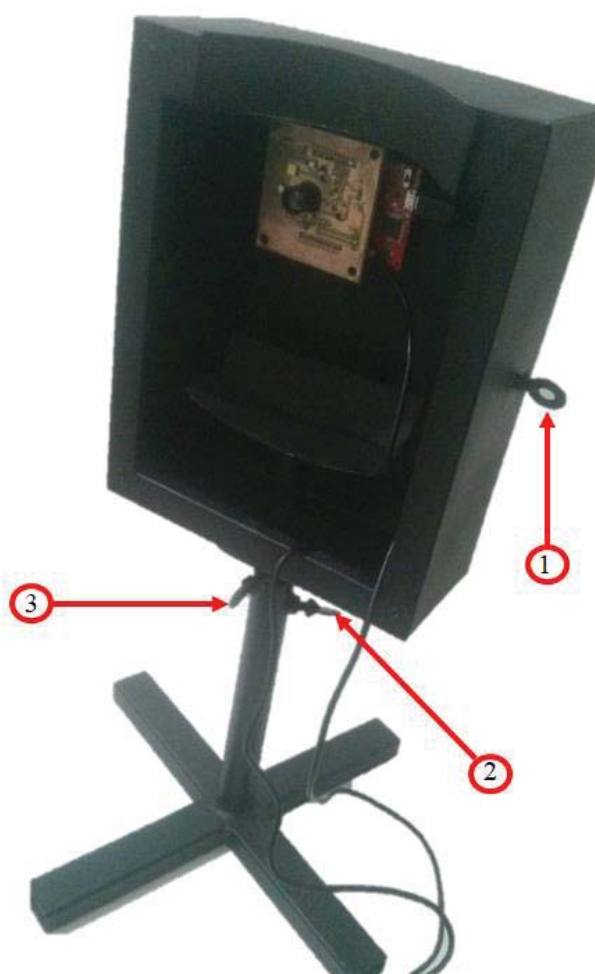
Figura 50 - Estrutura do projeto com encosto para a testa, descanso para o queixo e sistema de iluminação fixado.
