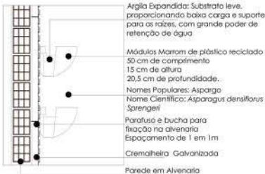
DETALHE PAREDE VERDE ESC: 1:10
