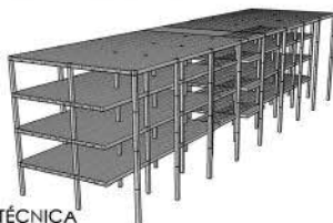
ESCOLA POLITÉCNICA SISTEMA ESTRUTURAL S/ ESC.
