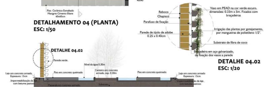
DETALHAMENTO 04 (CORTE) ESC: 1/50
