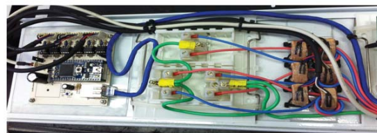
Figure 2: Módulo embarcado dentro do painel de gases de uma sala de cirurgia (2015)
