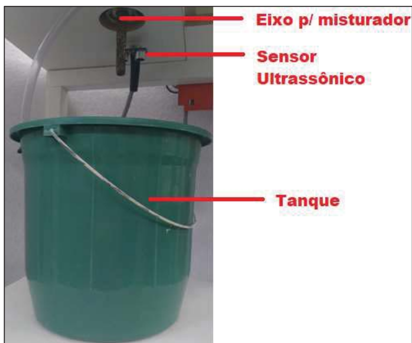
Figura 14 – Tanque de mistura
