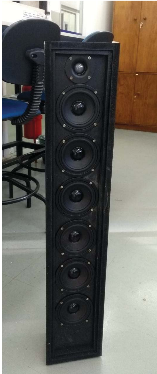
Figura 47 - Caixa Line Array Vertical Finalizada
