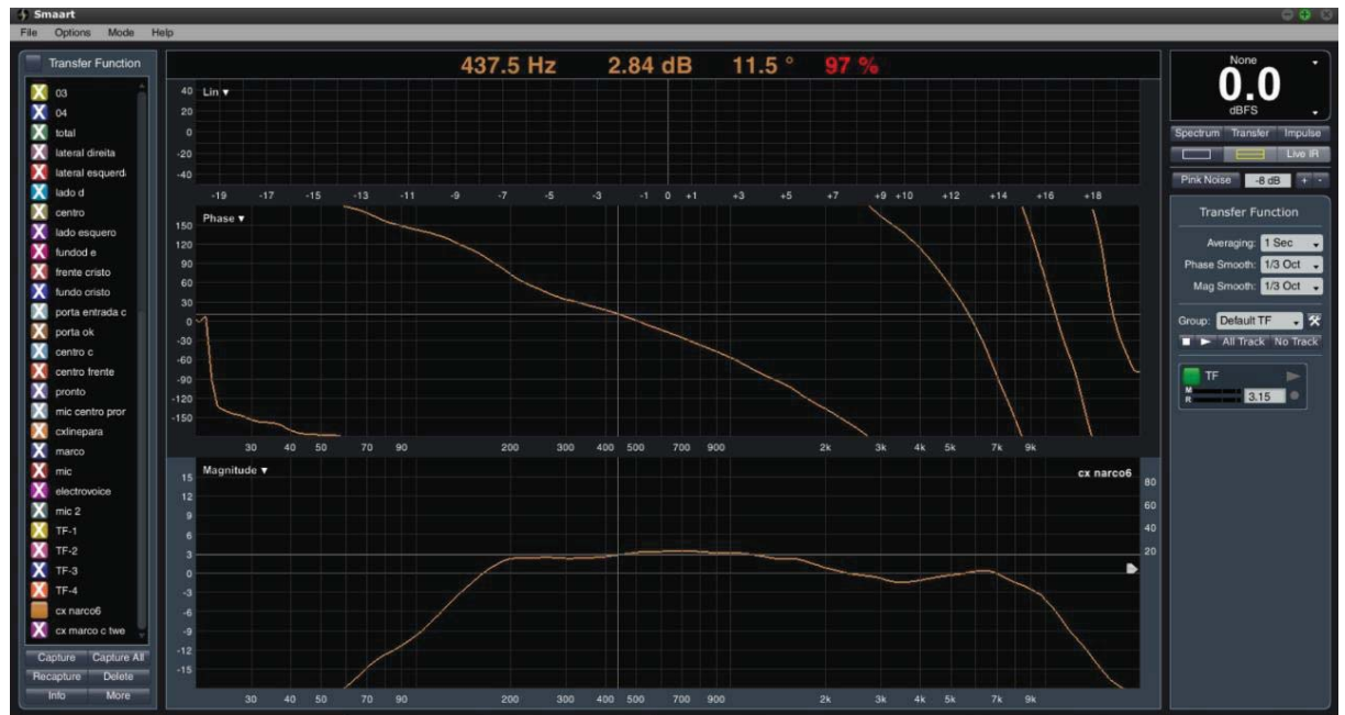
Figura 43 - Medição Caixa Line Sem Tweeter
