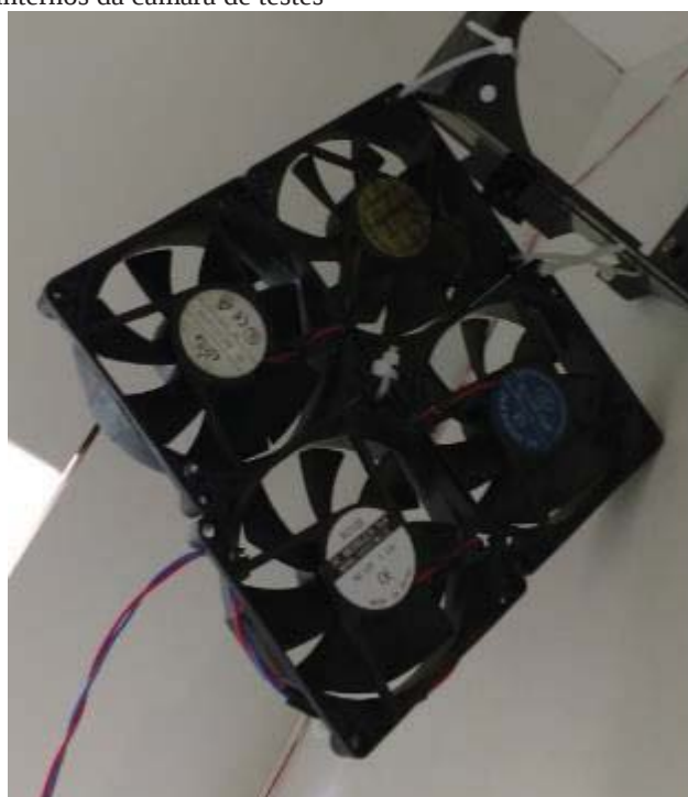
Figura 45 – Ventiladores internos da câmara de testes
