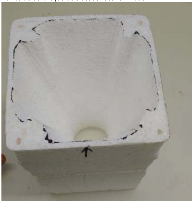
Figura 24 – cone do sistema 2.0 de ventilação do trocador economizador
