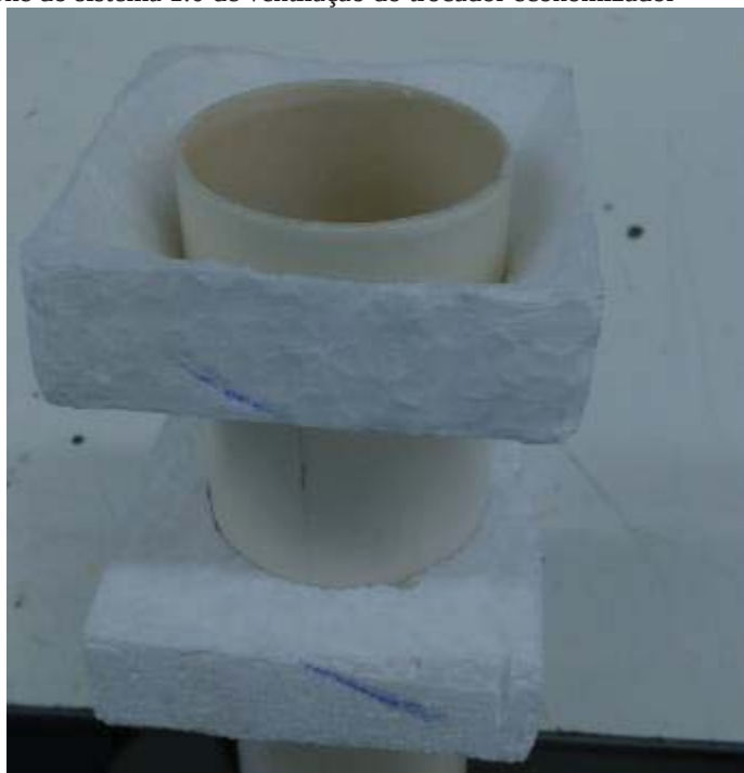
Figura 22 – peças do cone do sistema 1.0 de ventilação do trocador economizador
