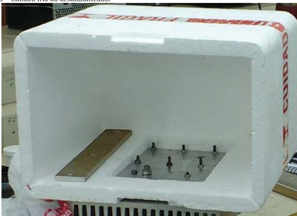
Figura 15 – Câmara fria do desumidificador
