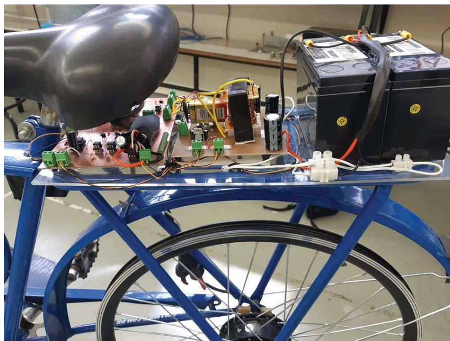
Figura 50- Alocação de baterias e placas de circuito impresso na bicicleta.
