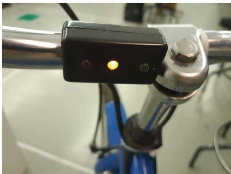
Figura 58- Visor de led's para monitoramento de estado da bateria do sistema.
