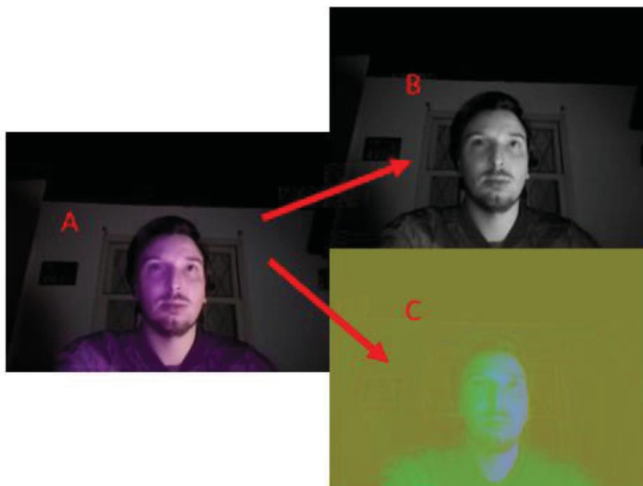
No processo de conversão de BGR para L.A.B é isolado o canal L, que é o indicativo de luminosidade, após essa separação é aplicado um filtro de mediana que serve para obter as informações da iluminação gradiente presentes na imagem, conforme a Figura 26.
