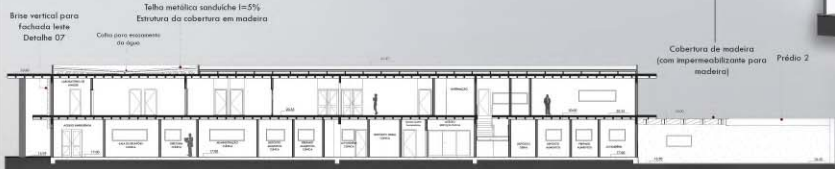
CORTE DD' PRÉDIO PRINCIPAL escala 1/150
