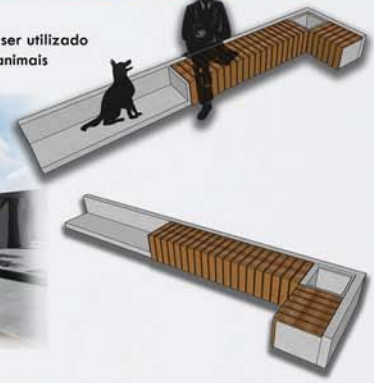
Muro de concreto com painel em MDF, cortado a laser, com tratamento contra umidade
