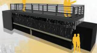
A plataforma de bicicletários foi pensada para ser utilizada em pontos estratégicos na cidade, preferencialmente na área central. O módulo possui estrutura metálica com capacidade para a fixação de bicicletas com segurança, proporcionando que a comunidade possa utilizar da ciclovia para o transporte ao trabalho de uma maneira saudável e segura.
