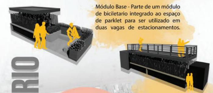
Módulo Base - Parte de um módulo de bicicletário integrado ao espaço de parklet para ser utilizado em duas vagas de estacionamentos.
