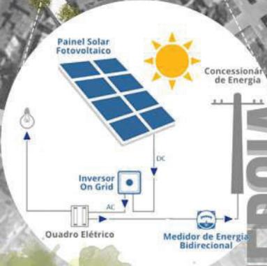
A captação de energia solar fotovoltaica é uma das estratégias de sustentabilidade aplicadas ao projeto. O espaço que se tem livre na área foi aproveitado para a colocação e toda a energia captada será utilizada na iluminação do parque.
