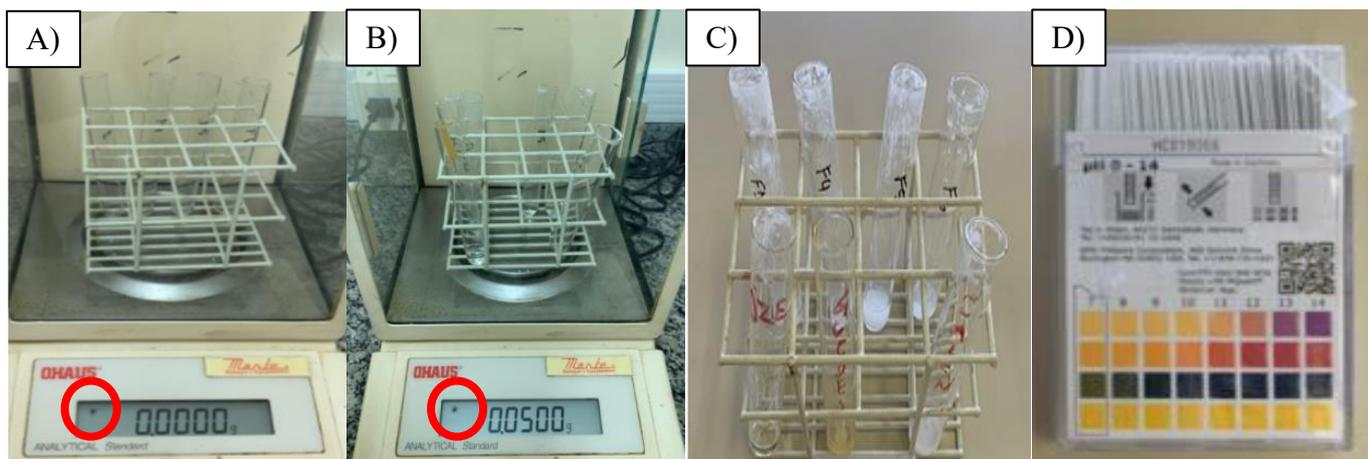
**Figura 1.** A) Balança tarada; B) 0.0500g de água destilada; C) Pastas diluídas em água; D) Fitas de determinação colorimétrica.
