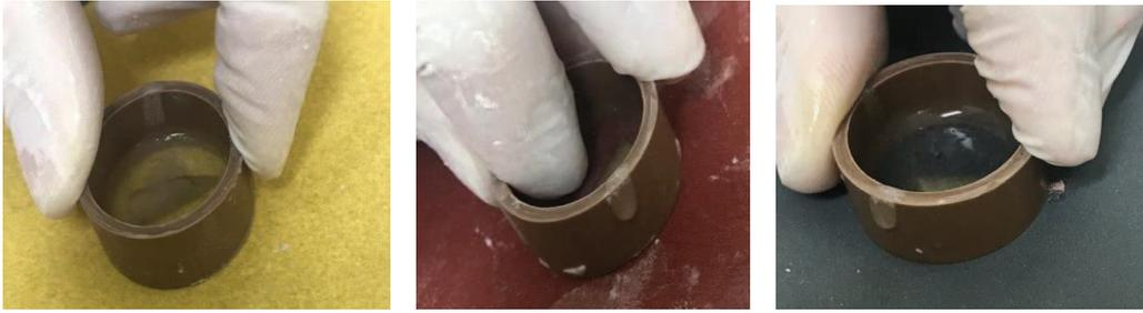
Figuras 8,9 e 10 – Amostras sendo lixadas com lixas abrasivas na sequência de granulação 180, 320 e 600.
