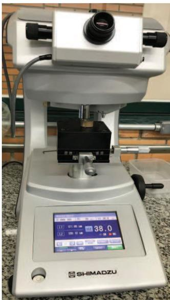
Figura 15 - Microdurômetro Vickers.
