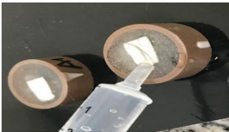
Figura 23 – Lavagem das amostras com 5 mL de água destilada.
