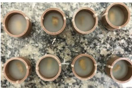
Figura 6 – Amostras fixadas em resina acrílica autopolimerizável.
