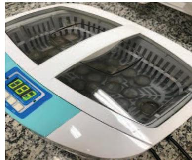
Figura 13 – Ciclo de lavagem na Cuba ultrassônica.
