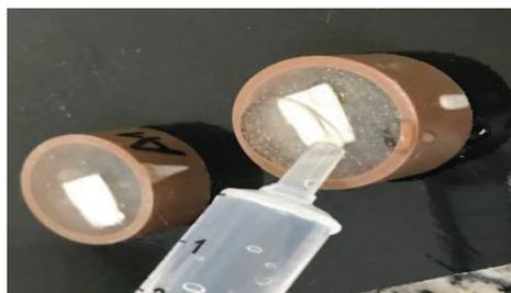
Figura 6 – Lavagem das amostras com 5 mL de água destilada.
