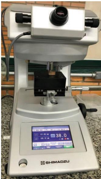
Figura 2 - Microdurômetro Vickers.
