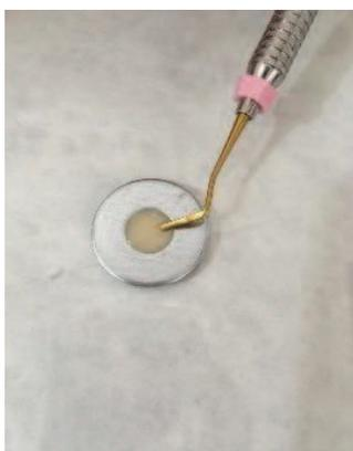
**Figura 2** – Inserção do incremento de resina composta, na matriz metálica com espátula, para evitar o contato com as luvas de látex.
