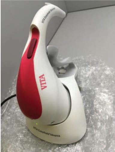
**Figura 6** – Vita Easyshade 4.0, aparelho utilizado para leitura das coordenadas de cor das amostras, antes e após o envelhecimento.
