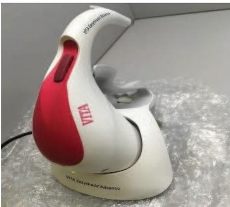
**Figura 3** – Vita Easyshade 4.0, aparelho utilizado para leitura das coordenadas de cor das amostras, antes e após o envelhecimento.
