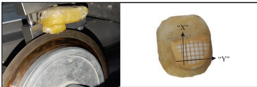
**Figura 2.** Corte das amostras nos sentidos “X” e “Y” com auxílio de um disco diamantado
