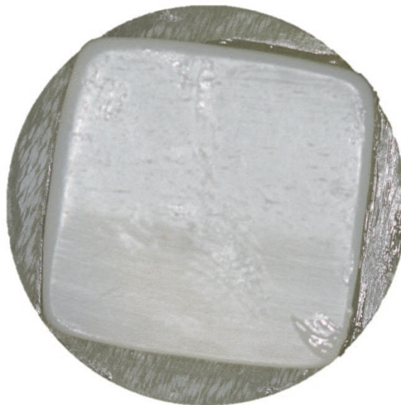
Figura 4 - Modelo do CP para o teste carga compressiva
