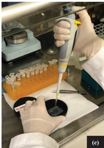
Figura 3: (a) Descalcificação; (b) Amostras em molde com resina; (c) Cortes com ultramicrotomo; (d) Amostras dispostas em grids; (e) Imersão em contraste; (f) MET.
