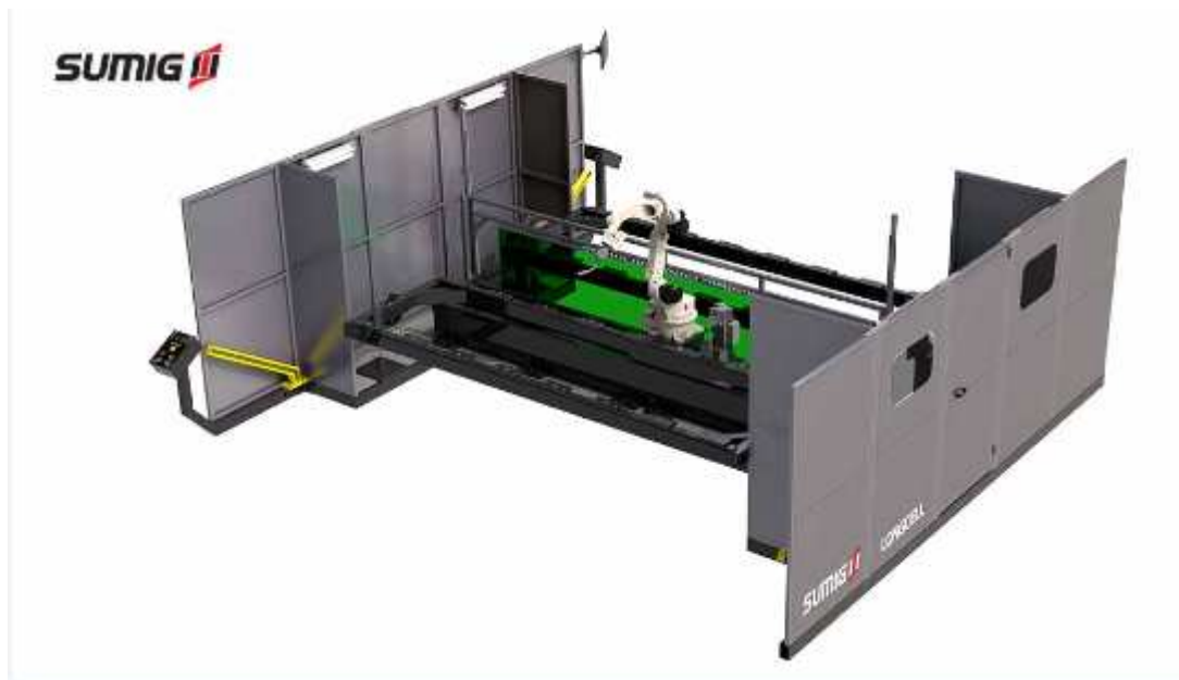
Figura 5 - Robô com deslocamento em trilhos.
