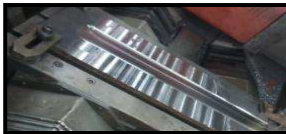
FIGURA 7 – Peça com o canal usinado.
