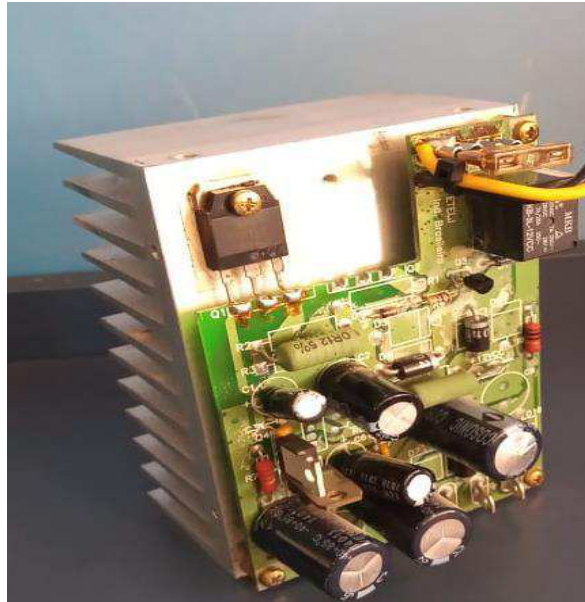
Figura 8 - Representação do transistor de potência acoplado no dissipador de calor padrão. Fonte: Autor, 2021.
