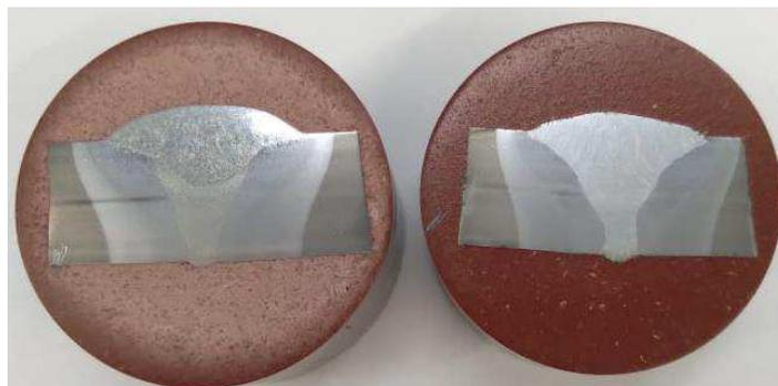
Figura 14 - Representação dos C.P. onde foram realizados ensaios de macrografia e micrografia.
