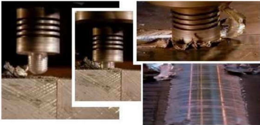
Figura 4 - Sequência do processo FSW e resultado da solda
