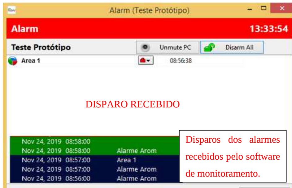
Figura 50 - Disparos dos alarmes de arrombamento recebidos pelo software de monitoramento.
