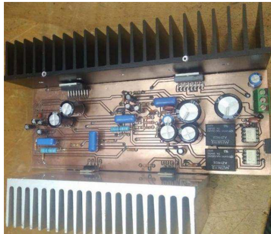
Figura 52 – Placa de circuito impresso dos Amplificadores já montada
