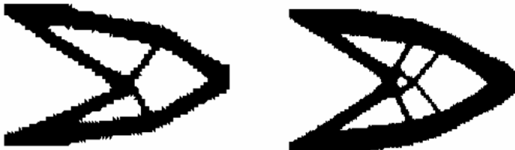
Figura 5 - Dependência da malha na otimização topológica Fonte: (SIMONETTI, 2009)
