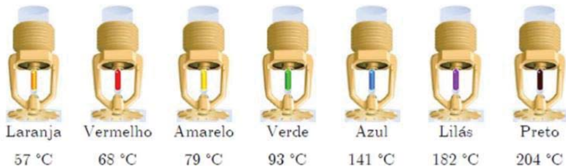
Figura 2 – Bulbos dos chuveiros automáticos.
