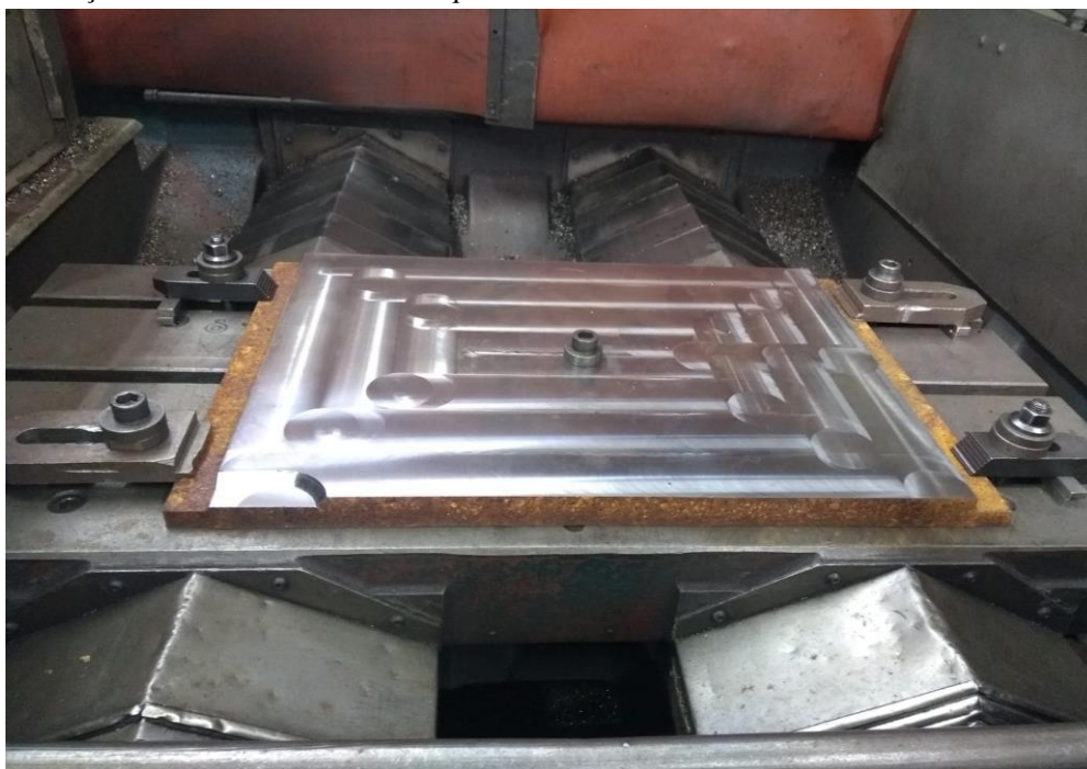
Figura 10- Fixação do material na mesa da máquina.
