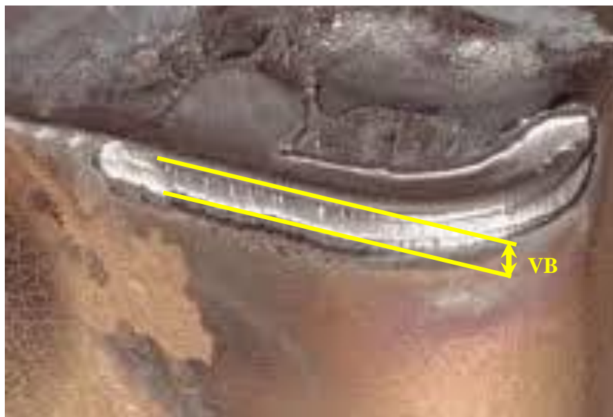
Figura 4 - Desgaste de Flanco
