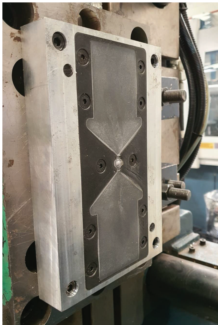
Figura 19 – Abertura do molde pós injeção
