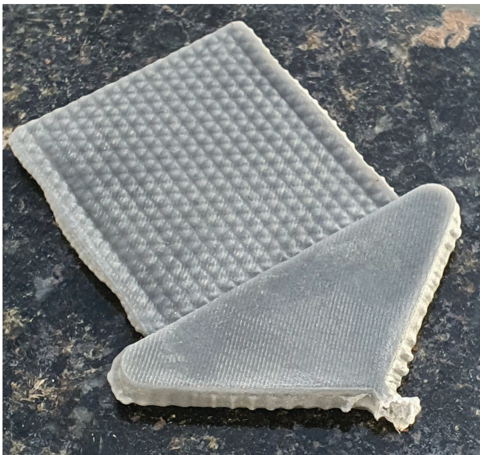
Figura 25 – Corpo de prova danificado
