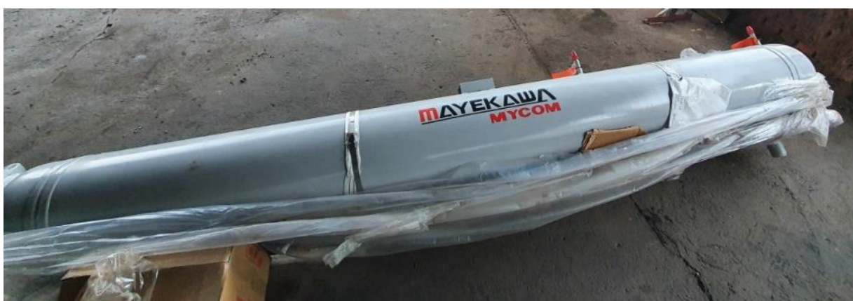
Figura 20 – Trocador de Calor Casco e Tubo Mayekawa Antes da Instalação.
