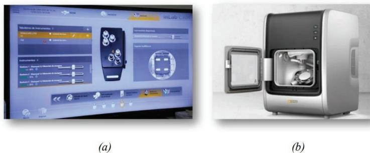
Figura 2: Programa CAD (a) e unidade CAM (b) do equipamento SIRONA INLAB McX5.
