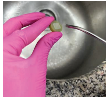
Fig. 4: Secagem da superfície do G10 com jatos de ar por 30s.
