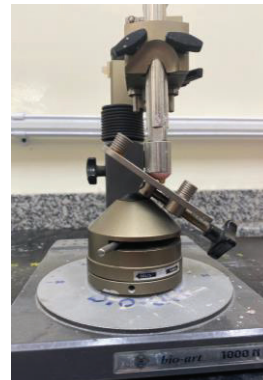
Fig. 17: Dente incluído ao suporte com uma inclinação de 45°.
