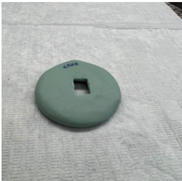
Fig. 8: Molde de silicone de condensação (frente).
