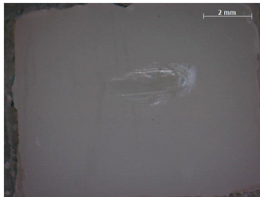
Figura 21. Faceta de desgaste resina convencional (controle).
