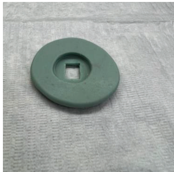
Fig. 9: Molde de silicone de condensação (atrás).
