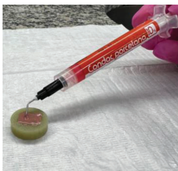
Fig. 2: Condicionamento do G10 com ácido fluorídrico 10% durante 1 min.
