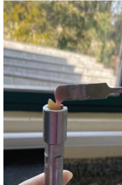
Fig.15: Inserção de resina acrílica com o dente já acoplado no suporte.
