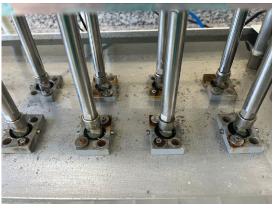
Fig. 18: Dentes e CPs acoplados na máquina de ciclagem mecânica pneumática.
