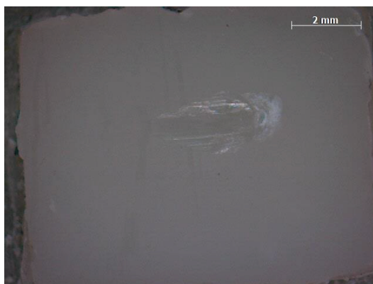
Figura 21. Faceta de desgaste resina convencional (controle).
