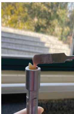
Fig.15: Inserção de resina acrílica com o dente já acoplado no suporte.
