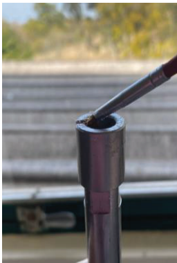
Fig. 14: Aplicação de vaselina no suporte da máquina de ciclagem mecânica pneumática.
