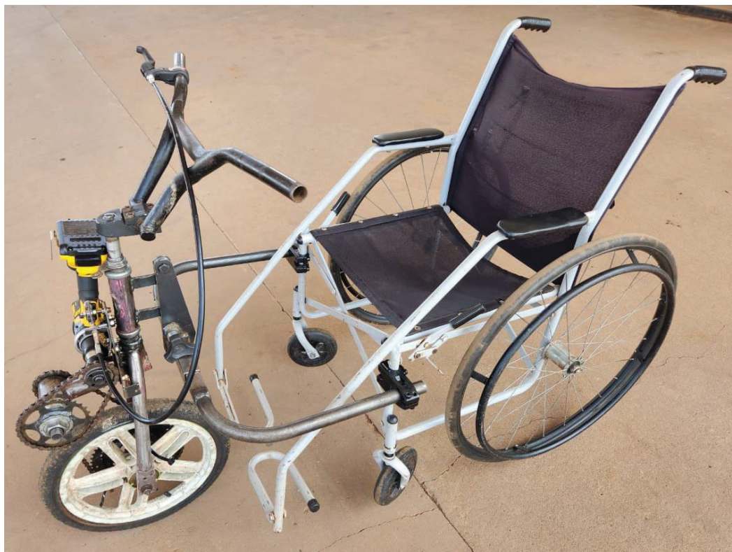
Figura 17 - Protótipo do acessório acoplado a cadeira de rodas mecanomaneal (Fonte: Autor, 2022)
