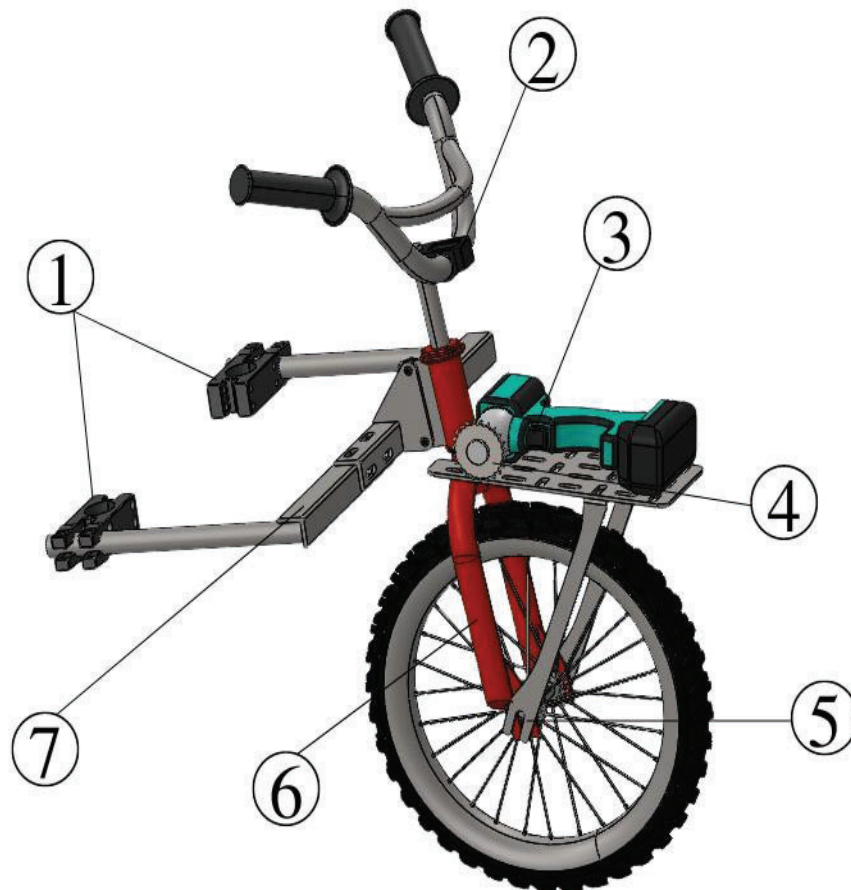
Figura 4 - Esquema conceitual do acessório com a cadeira de rodas.
