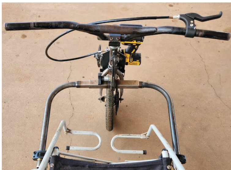
Figura 15 - Acoplamento (Fonte: Autor, 2022)
