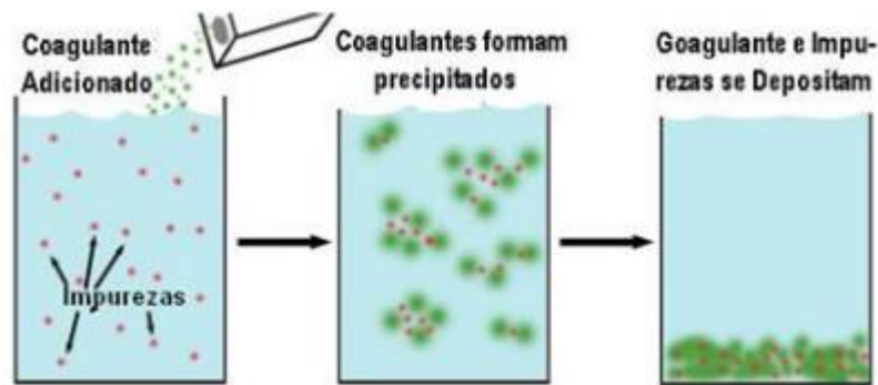
Figura 4: Ação do coagulante com o material suspenso
