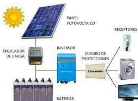
Figura 18- Sistema Fotovoltaico Autônomo
