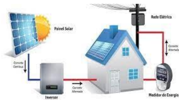
Figura 19- Sistema Fotovoltaico Conectado à Rede
