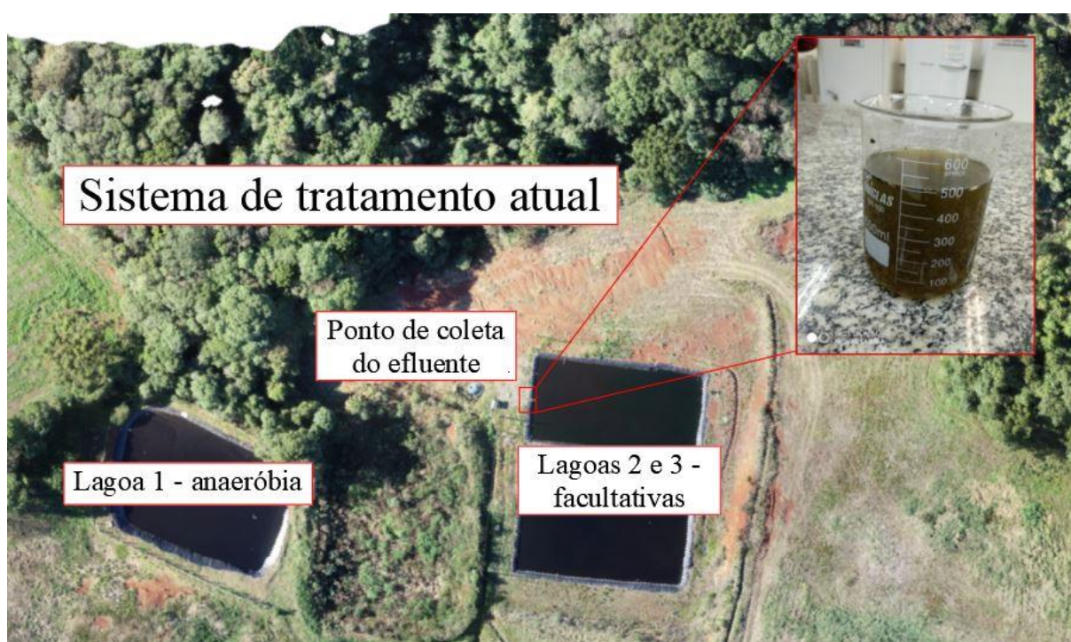
Figura 3: Sistema atual de tratamento no aterro sanitário e condição do efluente na coleta
