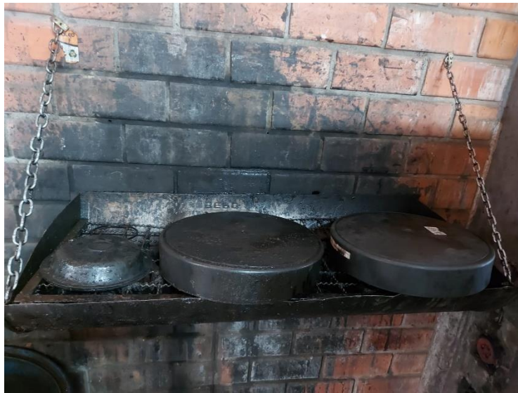
Figura 21 - Pingadeira, para escorrer galão de óleo.
