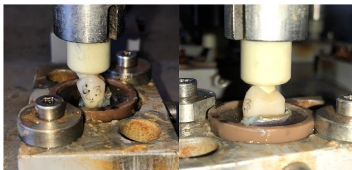
Figura 8 – posicionamento dos corpos de prova na cicladora mecânica pneumática. O pistão antagonista de G10 e o dente se tocam formando um tripoidismo.
