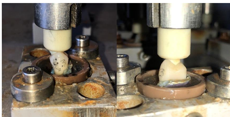
Figura 8 – posicionamento dos corpos de prova na cicladora mecânica pneumática. O pistão antagonista de G10 e o dente se tocam formando um tripoidismo.
