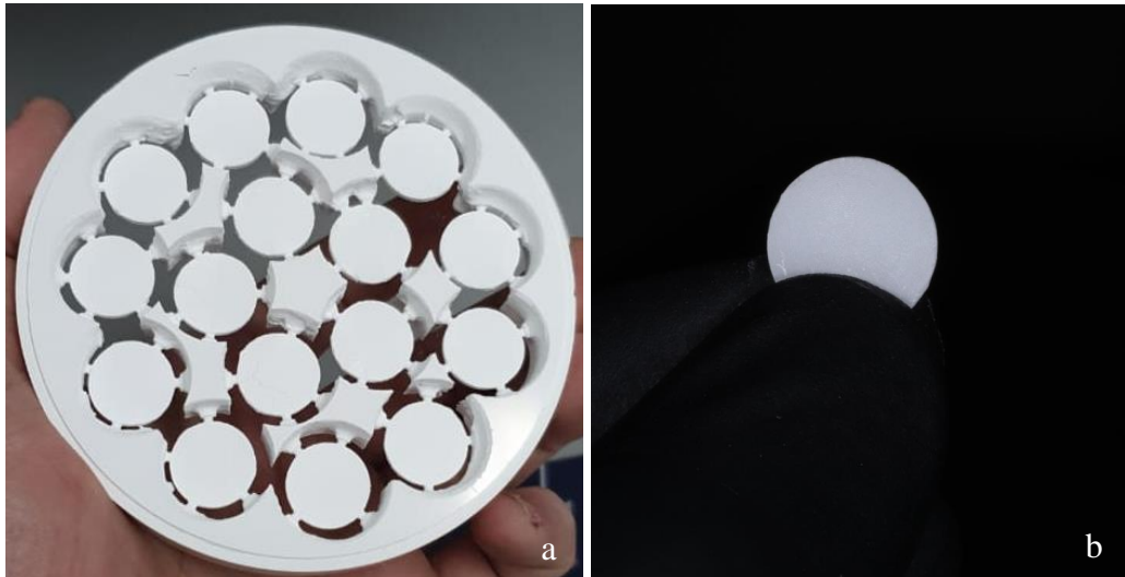
Figura 4: (a) CPs após usinagem em CAD-CAM e (b) CP sinterizado.
