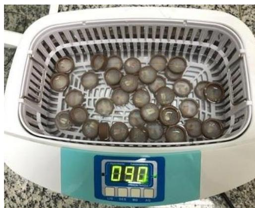
**Figura 9** - Ciclo de lavagem na cuba ultrassônica.
