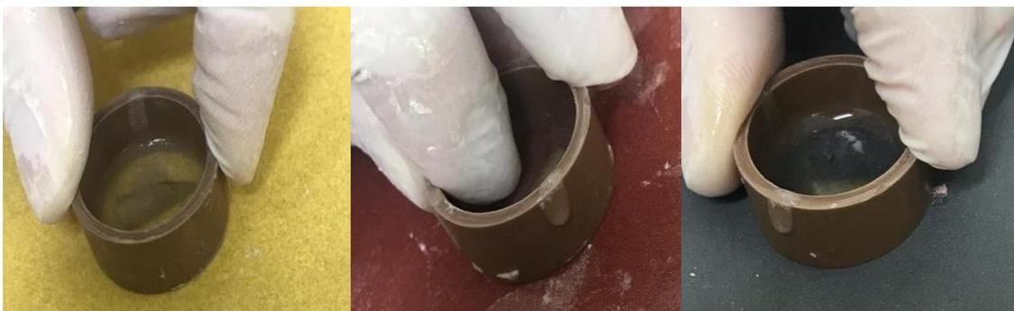
**Figura 5, 6 e 7** - Amostras sendo lixadas com lixas abrasivas na sequência de granulação 180, 320 e 600.
