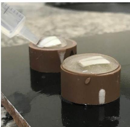
**Figura 12** – Lavagem das amostras com 5 mL de água destilada.
