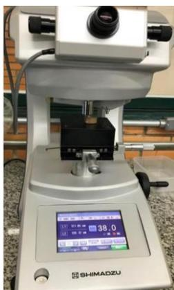
**Figura 10** - Microdurômetro Vickers.
