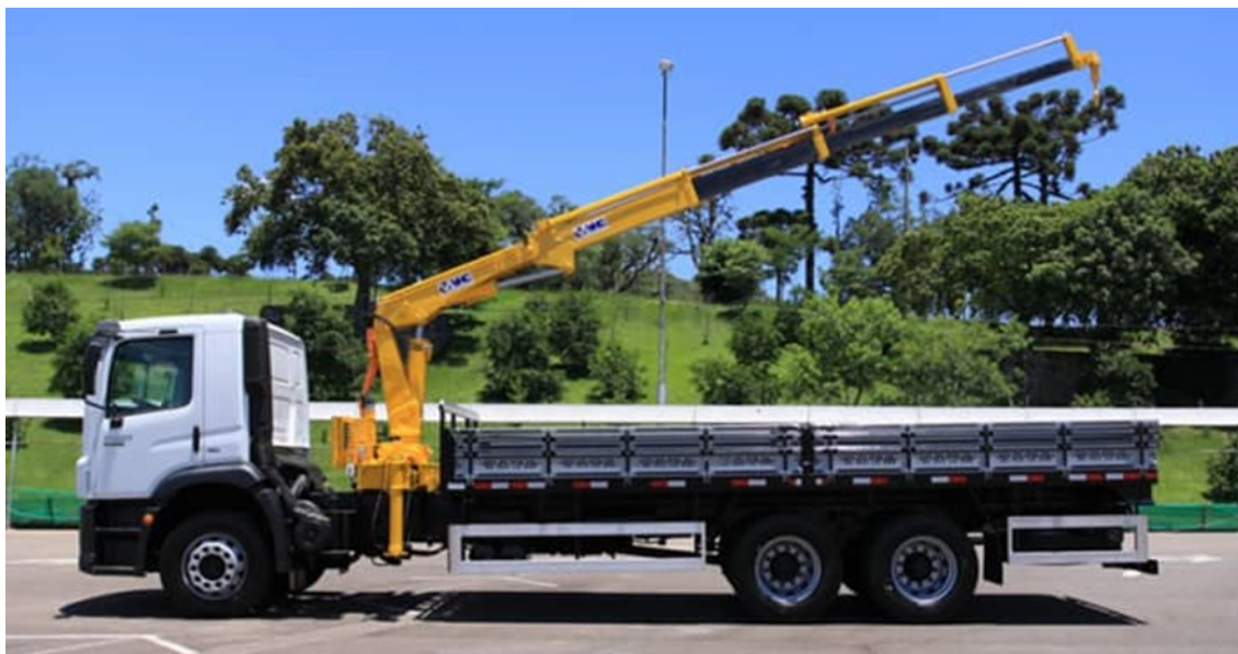
Figura 5 – Caminhão munck utilizado para montagem
