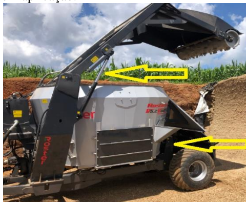
Figura 14 – Cilindros hidráulicos em aplicação.
