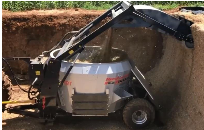
Figura 10 – Vagão misturador com sistema hidráulico
